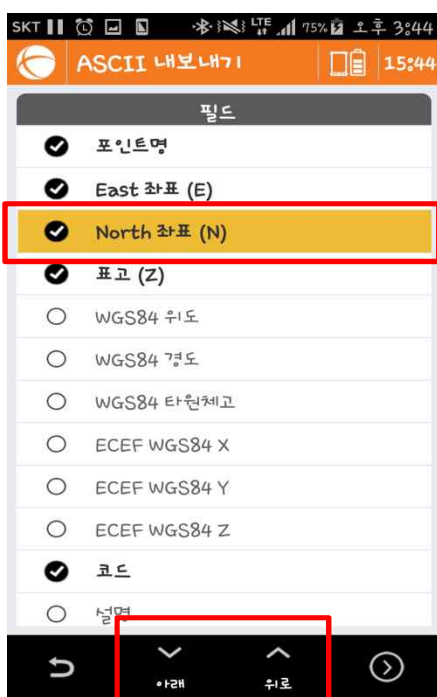
보통 엑셀에 표현할 때 측점명-X좌표-Y좌표-표고 순으로 하기 때문에 North(N)을 선택 후 하단의 위로 버튼을 눌러줍니다.
